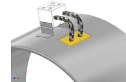
8. Тип №8 – Клеммная колодка закрытая коробкой.
